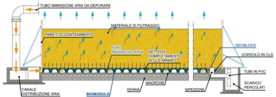
l'attecchimento di una biomassa ad ampio spettro (batteri, attinomiceti e funghi) per la metabolizzazione di composti naturali e di sintesi inorganici e organici, sia aromatici che alifatici quantitativo totale: circa 200 m<sup>3</sup>, per un'altezza del letto filtrante di 2 m circa.
