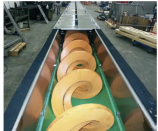
Il materiale da convogliare viene trasportato dall'elica che ruota su barre antiusura o su polietilene ad alta densità molecolare a seconda del tipo di materiale da trasportare. Le eliche possono essere fornite con spirale singola o doppia.
